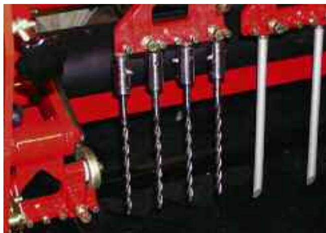
Bohrer am Vertidrain-Gerät
