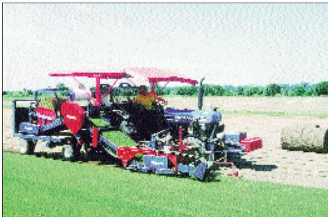
Abb. 1: Produktion der 60er-Rolle an der Schälstelle
