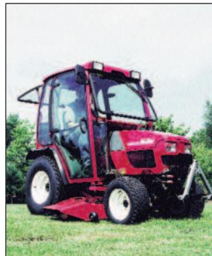
Dreizylinder-Dieselmotor und Allradantrieb über einen hydrostatischen, also stufenlosen Fahrtrieb. Der Bediener erhält eine robuste, lauffähige Arbeitsmaschine mit zweistufiger Untersetzung für optimale Zugkraft unter allen Einsatzbedingungen und mit Tempomat!
