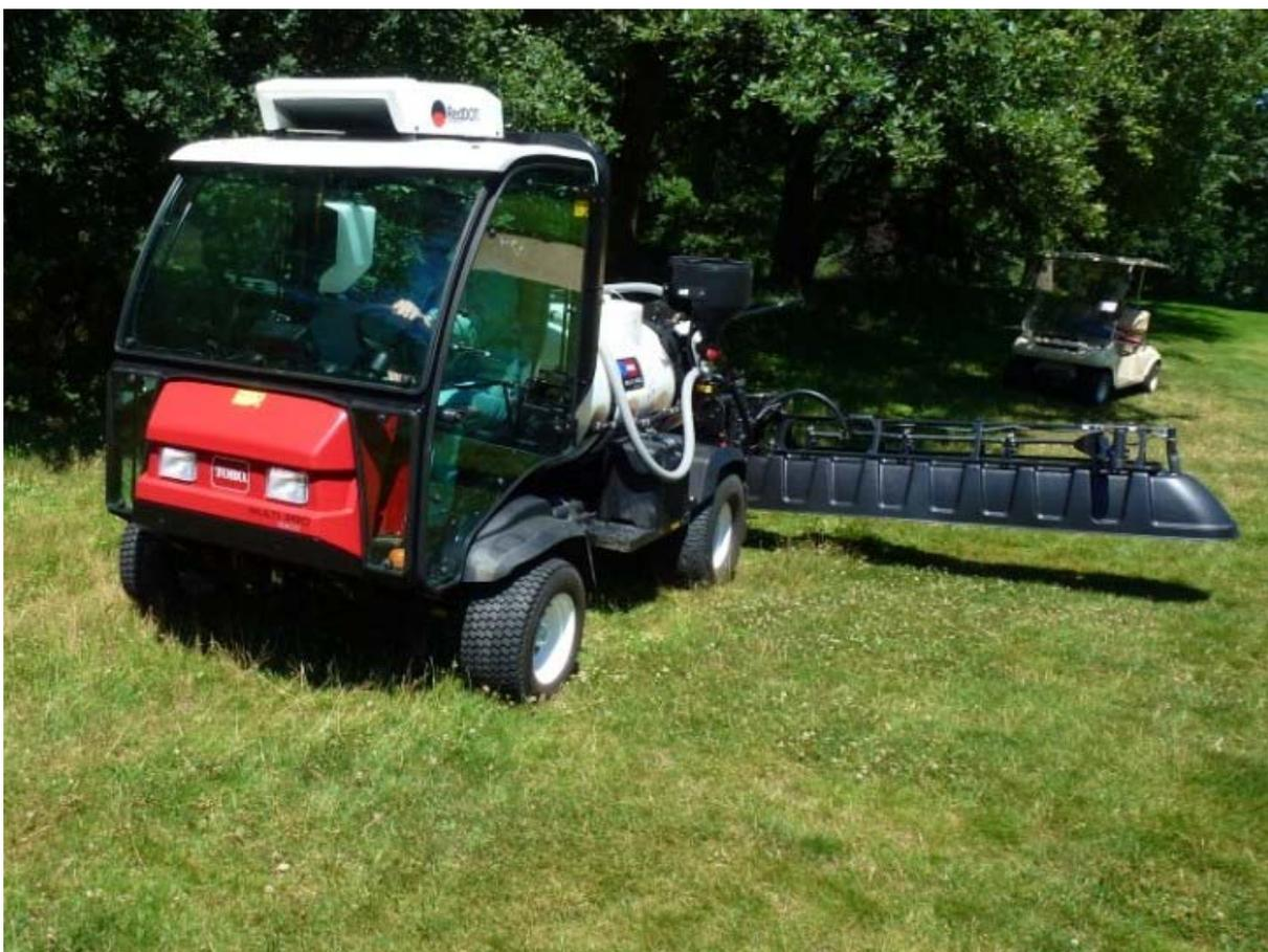
Abdriftminderndes selbstfahrendes Spritzgerät (Hinweis: der Head-Greenkeeper fährt im Golfcart mit, um die anschließende Pflanzenschutzmaßnahme zu kontrollieren)
