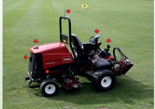
Für den automatisierten Einsatz modifiziertes herkömmliches Mähgerät. Rote Pfeile zeigen Veränderungen (Foto und Bearbeitung: Morhard)
