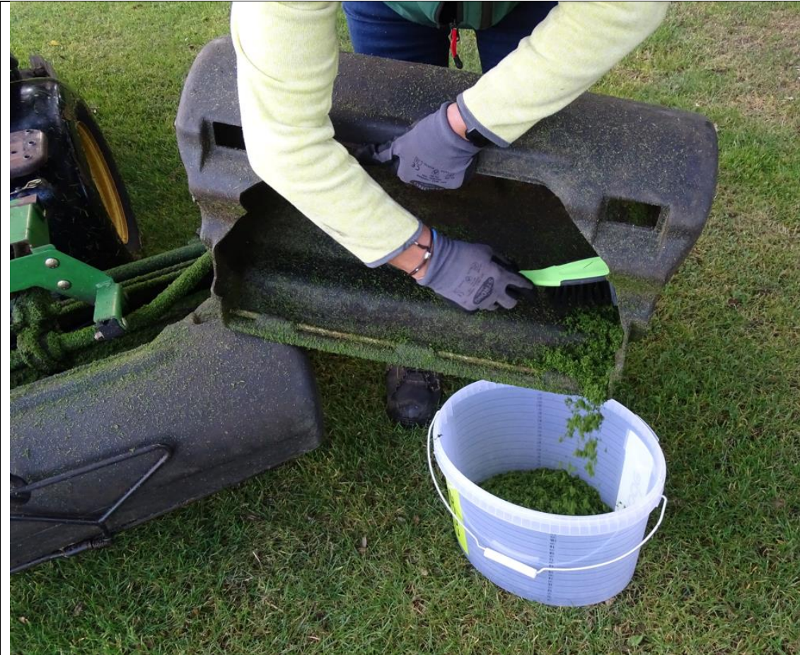
Abb. 4: Leerung der Fangkörbe in den Messbehälter (Skalierung in Liter) zur Ermittlung des Schnittgutvolumens je Grün. Foto: Dr. K.G. Müller-Beck
