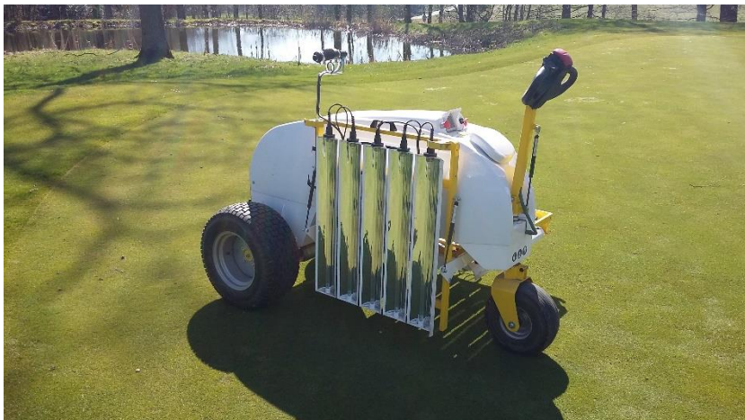
Abb. 1: UV-C Behandlungsgerät zum Einsatz gegen Rasenkrankheiten (Foto: Prämaßing)
