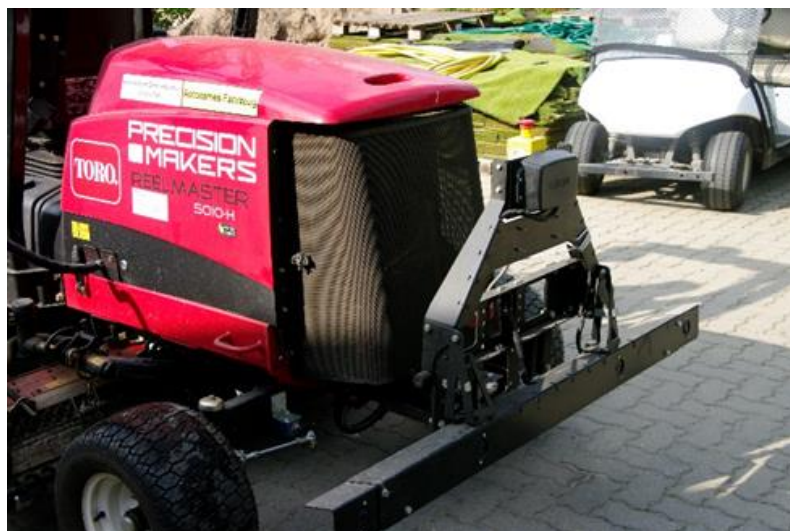
Abbildung 8 Hinterer Ultraschall-Sensor und Notaus-Schalter bei einem Fairwaymäher mit autonomer Steuerung (Abbildung: ILOS)
