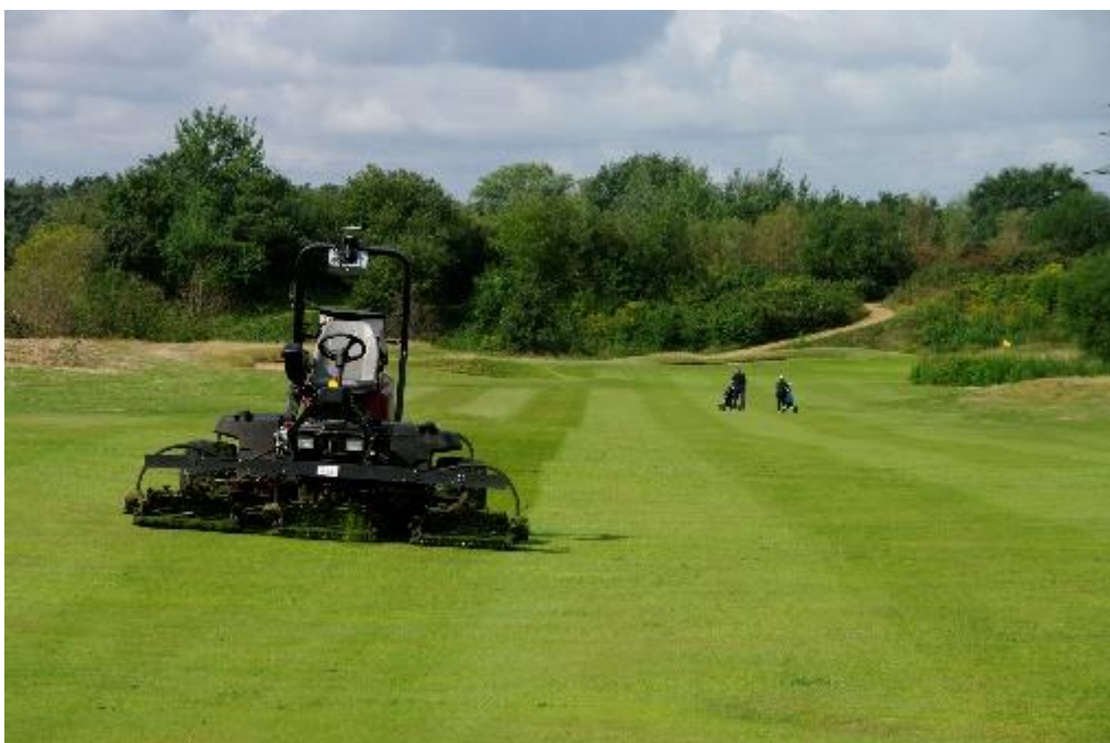
Abbildung 3 Fairwaymäher mit autonomer Steuerung (Abbildung: ILOS)
