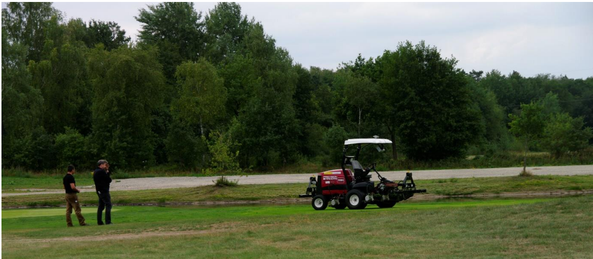
Abbildung 12 Betrieb eines herkömmlichen Fairwaymähers mit autonomer Steuerung unter Aufsicht (Abbildung: ILOS)
