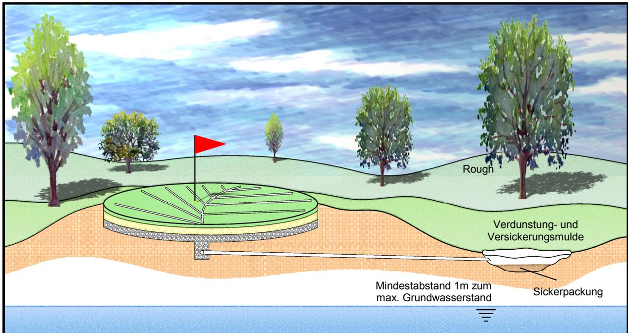
Beispiel einer korrekten Dränagewasserableitung mit offenem sichtbarem Auslauf und Versickerung in einer angelegten Versickerungs- und Verdunstungsmulde.
